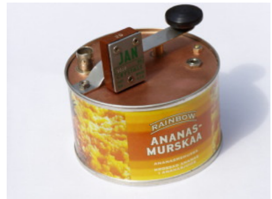
Ananaspurkkiin ITE-tehty kidelähetin by OH1BS
